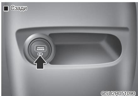
Зарядное устройство USB предназначено для зарядки батарей компактных электрических устройств с помощью USB-кабеля.
