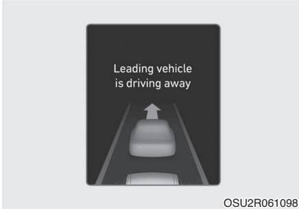
Если транспортное средство впереди трогается с места, функция контроля отъезда впереди стоящего автомобиля остановленного впереди, уведомляет об этом водителя путем отображения сообщения «Leading vehicle is driving away» (Идущий впереди автомобиль отъезжает) на комбинации приборов и подачи предупреждающего звукового сигнала.
