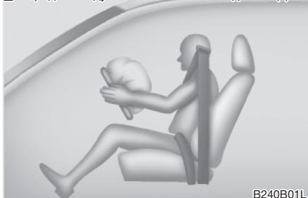
Модули передних подушек безопасности располагаются в центре рулевого колеса и на передней панели салона, над вещевым ящиком. Когда блок управления подушками безопасности обнаруживает достаточно серьезный удар в переднюю часть транспортного средства, он автоматически надувает передние подушки безопасности.
