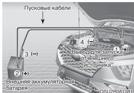
4. Присоедините кабели для запуска двигателя от внешнего источника (пусковые кабели), строго следуя указанной на рисунке последовательности. Сначала подсоедините один конец пускового кабеля к красному плюсовому (+) выводу разряженной АКБ (1).
