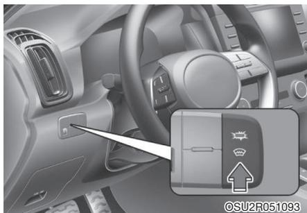
При работающем двигателе обогреватель нагревает ветровое стекло для устранения инея, запотевания и ледяного налета изнутри и снаружи.
