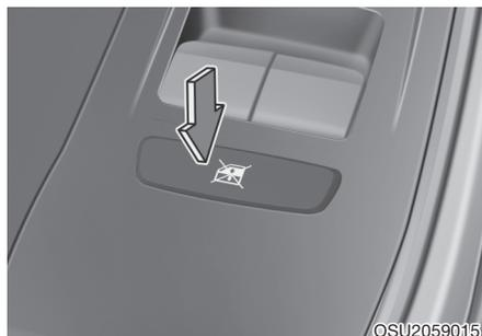
Водитель может заблокировать переключатели электростеклоподъемников задних дверей, нажав выключатель блокировки.
