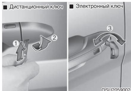
Необходимо повернуть ключ в сторону задней части автомобиля для разблокирования и в сторону передней части автомобиля для блокирования замка двери.
