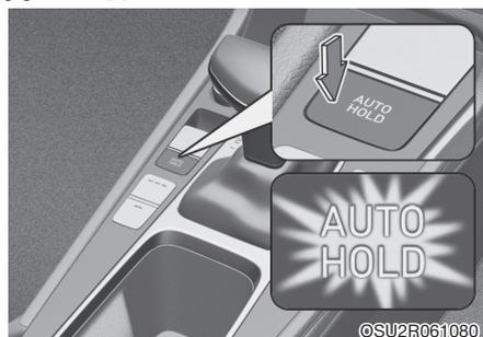
1. Когда закрыты дверь водителя и капот, выжмите педаль тормоза, затем нажмите на переключатель [AUTO HOLD] (автоматическое удержание). Загорится белый индикатор «AUTO HOLD» (автоматическое удержание) и система перейдет в режим ожидания.
