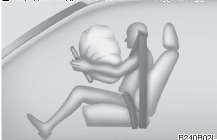
После срабатывания происходит разрыв швов мягкой крышки, которая отделяется под давлением при расширении подушек безопасности. Срыв крышек позволяет подушкам безопасности раскрыться полностью.
