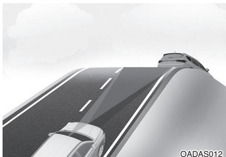
При движении на подъеме или спуске система интеллектуального круиз-контроля может не обнаружить транспортное средство, движущееся в вашей полосе, и ваш автомобиль может ускориться до заданной скорости. Кроме того, скорость автомобиля может резко снизиться при внезапном обнаружении транспортного средства впереди.
