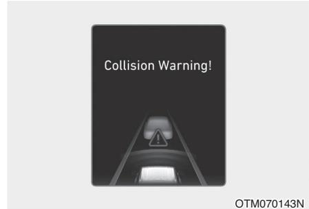
Если система интеллектуального круиз-контроля работает и возникает опасность потенциального столкновения с впереди идущим транспортным средством, на комбинации приборов появляется предупреждающее сообщение «Collision Warning» (Угроза столкновения!) и раздается предупреждающий звуковой сигнал для уведомления водителя. Всегда следите за дорогой во время движения и при необходимости нажимайте педаль тормоза для снижения скорости в целях поддержания безопасной дистанции.
