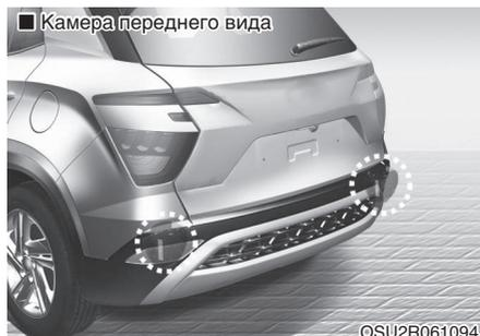
Задние угловые радары представляют собой датчики, расположенные внутри заднего бампера, которые обнаруживают объекты сзади и сбоку автомобиля. Всегда следите за чистотой поверхности заднего бампера для надлежащей работы системы предупреждения об опасности выхода из автомобиля.
