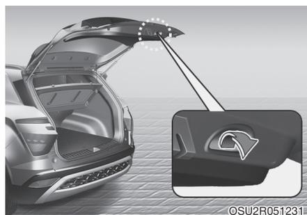
Чтобы закрыть багажное отделение, опустите дверь багажного отделения и надавите на нее до блокировки замка. Всегда проверяйте надежность закрытия двери багажного отделения, потянув ее вверх за ручку двери багажного отделения, не нажимая кнопку на ручке.
