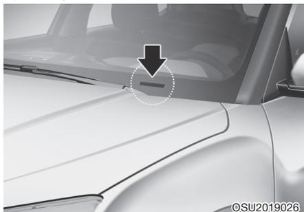
Кроме того, номер VIN указан на пластинке, которая прикреплена к верхней части приборной панели. Номер, нанесенный на пластинку, виден снаружи через ветровое стекло.
