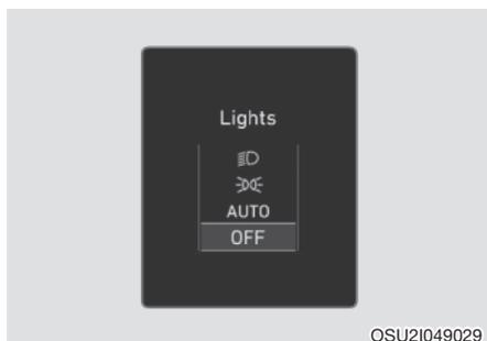
Этот индикатор отображает включенные приборы наружного освещения.
