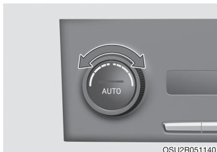
2. Поверните ручку регулятора температуры для выбора требуемого значения. Если температура будет установлена на самое низкое значение (LO), кондиционер будет работать постоянно.
