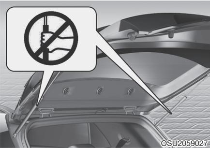
Не беритесь за детали (газонаполненные упоры), которые удерживают дверь багажного отделения в открытом положении. Помните о том, что в случае деформации детали возможно повреждение автомобиля или получение травмы.
