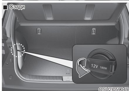
Электрическая розетка предназначена для питания мобильных телефонов или иных устройств, предназначенных для работы в электрической системе автомобиля. Устройства не должны потреблять более 180 Вт при работе двигателя.
