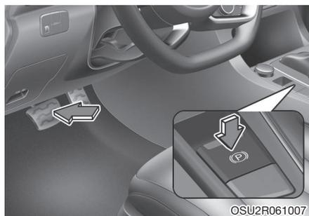
Чтобы отпустить EPB (электрический стояночный тормоз), нажмите выключатель EPB при следующих условиях:
