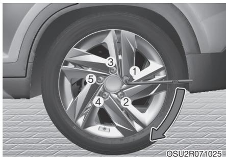
13. С помощью ключа для колесных гаек закрутите гайки крепления колеса в показанной последовательности. Выполните повторный контроль затяжки каждой гайки. После замены колес следует как можно быстрее обратиться к уполномоченному производителем дилеру / сервисному партнеру для затяжки гаек крепления колеса номинальным моментом. **Момент затяжки гаек крепления колеса: 11–13 кгс·м (79–94 фунт-сила·фут).**
