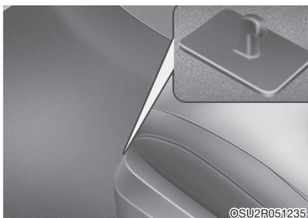
Передние коврики пола ВСЕГДА должны быть прикреплены к автомобилю с помощью специальных фиксаторов. Фиксаторами на ковре переднего пола коврики удерживаются от смещения вперед.
