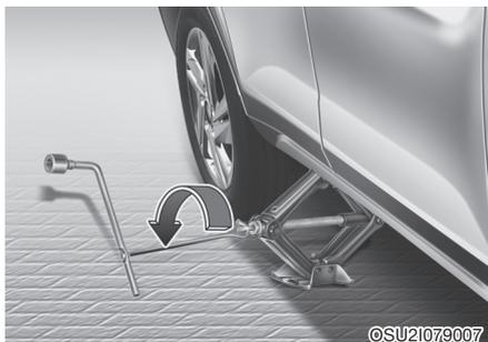
8. Вставьте рукоятку домкрата и, поворачивая ее по часовой стрелке, поднимите автомобиль до полного отрыва колеса от земли. Убедитесь, что поднятый домкратом автомобиль устойчив.
