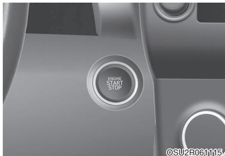
При открывании передней двери загорается подсветка кнопки пуска/останова двигателя. Через 30 секунд после закрывания двери подсветка гаснет.
