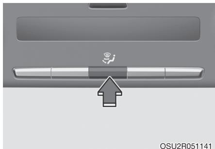
Кнопка выбора режима распределения воздуха управляет направлением потоков воздуха через систему вентиляции.
