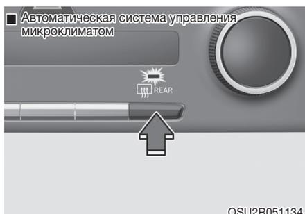
При работающем двигателе обогреватель нагревает заднее стекло для устранения инея, запотевания и ледяного налета изнутри и снаружи.
