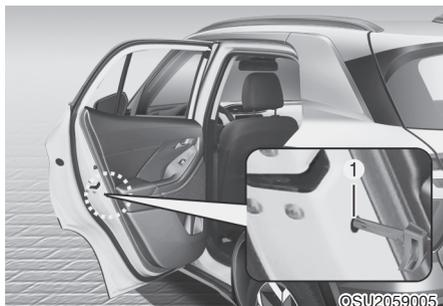
Устройство блокировки замков задних дверей предназначено для предотвращения их случайного открывания детьми, находящимися внутри автомобиля. Устройство блокировки замка для защиты детей должно использоваться всегда, когда в автомобиле находятся дети.
