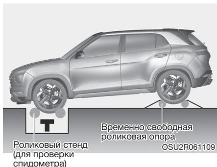
Роликовые стенды для автомобилей с приводом на одну ось непригодны для проверки автомобилей с постоянным полным приводом. Если для проверки приходится использовать роликовый стенд, предназначенный для автомобилей с приводом на одну ось, выполните следующие действия.
