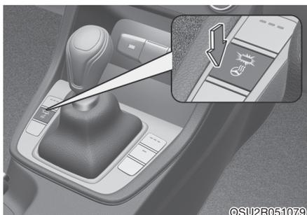
Обогрев рулевого колеса включается нажатием кнопки при включенном зажигании или при работающем двигателе.
