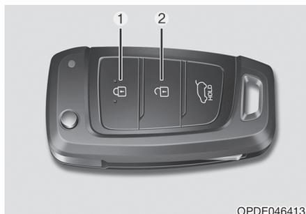
Для блокирования дверей нажмите кнопку блокирования дверей (1) на дистанционном ключе.
