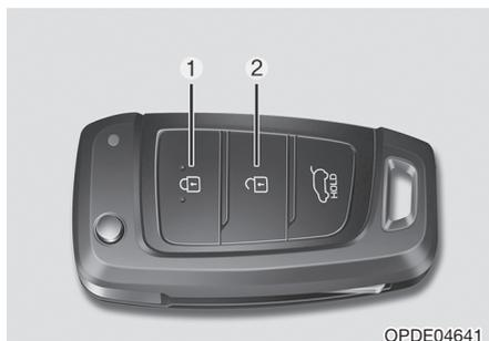
В автомобиле применяется пульт дистанционного управления, который можно использовать для блокировки или разблокирования дверей (включая дверь багажного отделения) и даже для запуска двигателя.
