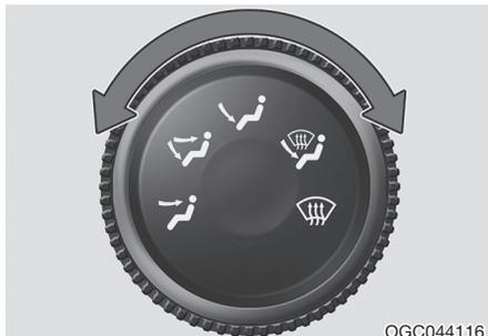
Ручка выбора режима распределения воздуха предназначена для управления потоком воздуха в системе вентиляции.
