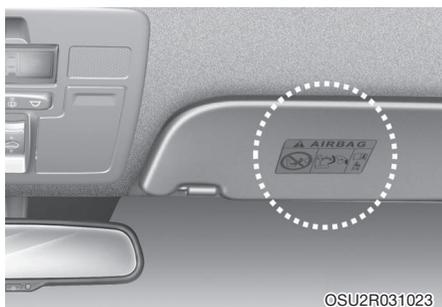
Предупреждающие наклейки прикрепляются к модулям подушек безопасности для того, чтобы уведомить водителя и пассажиров об опасности, связанной с системой подушек безопасности. Необходимо ознакомиться с предупреждениями в отношении системы подушек безопасности, изложенными в руководстве по эксплуатации.
