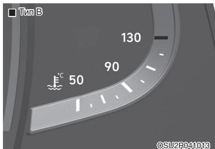
Этот прибор показывает температуру охлаждающей жидкости двигателя, когда выключатель зажигания находится в положении ON.
