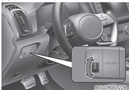
Для регулировки наклона фар в соответствии с количеством пассажиров и весом груза в багажном отделении следует повернуть ручку регулятора угла наклона фар.
