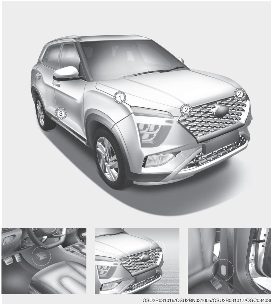
1. Блок управления системой SRS
