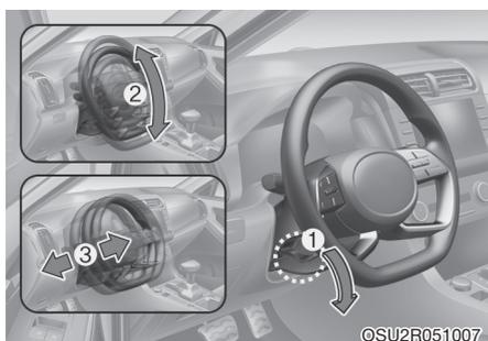
Для изменения угла наклона и высоты рулевого колеса:
