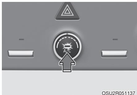
Для включения системы кондиционирования нажмите кнопку A/C (при этом загорится расположенный в ней индикатор). Повторное нажатие на эту кнопку приводит к выключению системы кондиционирования.
