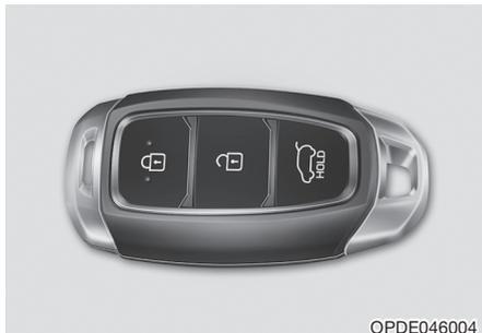
Для блокирования дверей используется кнопка на наружной ручке двери (при этом необходимо иметь при себе электронный ключ) или кнопка блокирования дверей на электронном ключе.
